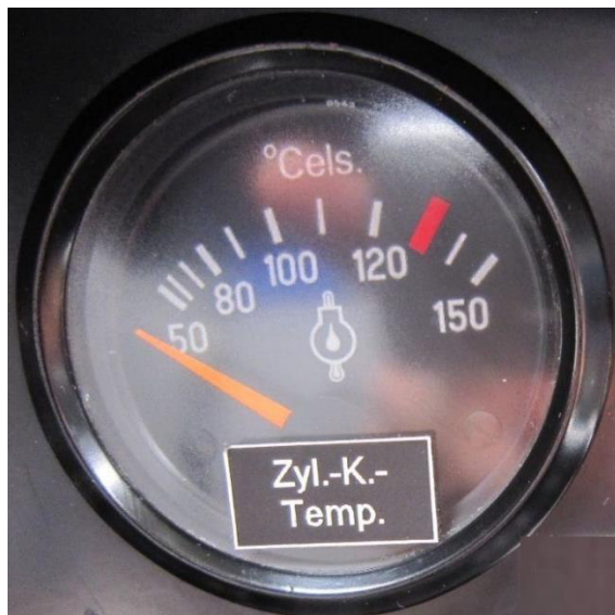
Figure 1: Old CHT indicator Alte Zylinderkopftemperaturanzeige
