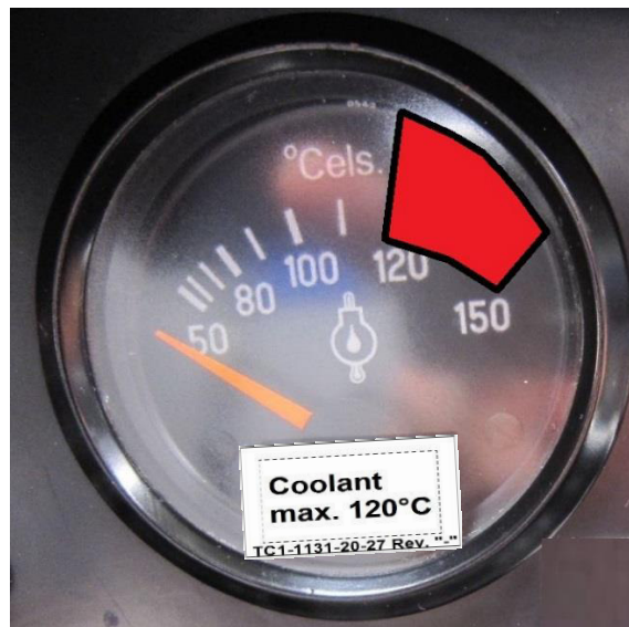
Figure 2: Modified CT indicator Modifizierte Kühlmitteltemperaturanzeige
