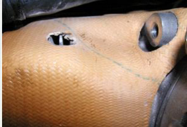
Bild 2: Ausfräsung für Schraubenkopf (links) Picture2: Notch for bolt head (left)
