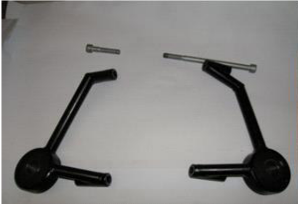
Bild 1: Hilfsmotorträger und Schrauben Picture 1: Engine brackets and bolts
