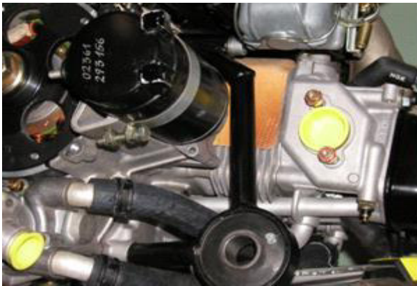
Bild 3: rechte Schraube M10x150 Picture 3: right-hand bolt M10x150
