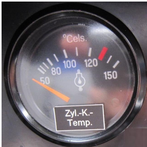
Figure 1: Old CHT indicator Alte Zylinderkopftemperaturanzeige
