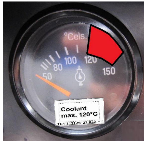
Figure 2: Modified CT indicator Modifizierte Kühlmitteltemperaturanzeige
