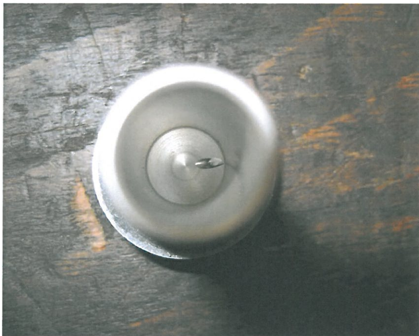
Bild 3 – Span innerhalb der Öleinfüllschraube
