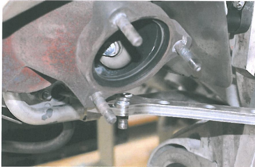
Bild 2 Wastegatehebel mit Gegenhalter in Position halten
