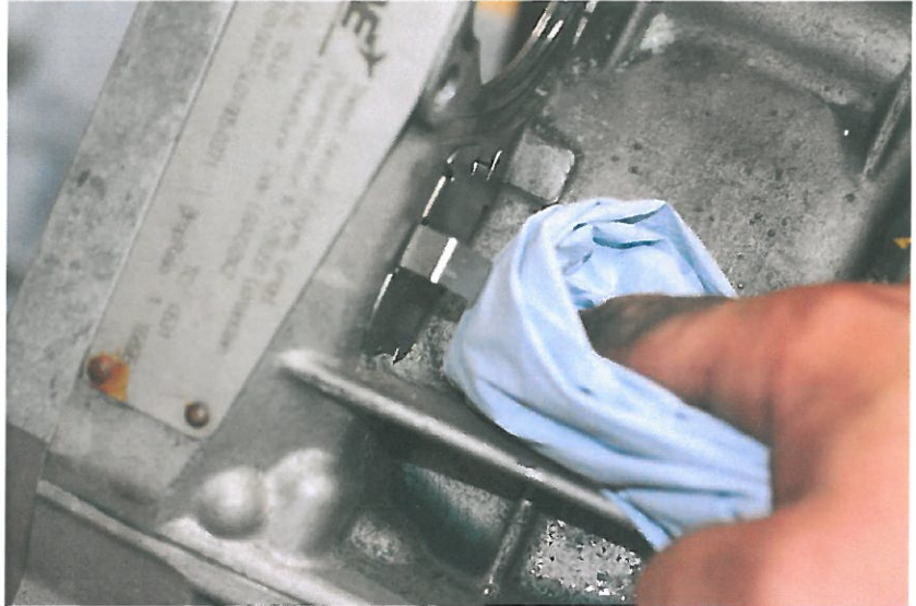
Bild 1 – Reinigung der Montageöffnung / Fig. 1 – Clean the assembly opening
