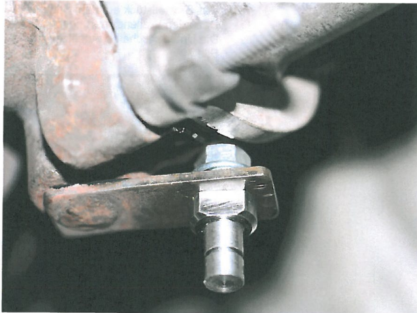
Bild 6 Befestigung des neuen Stiftes
