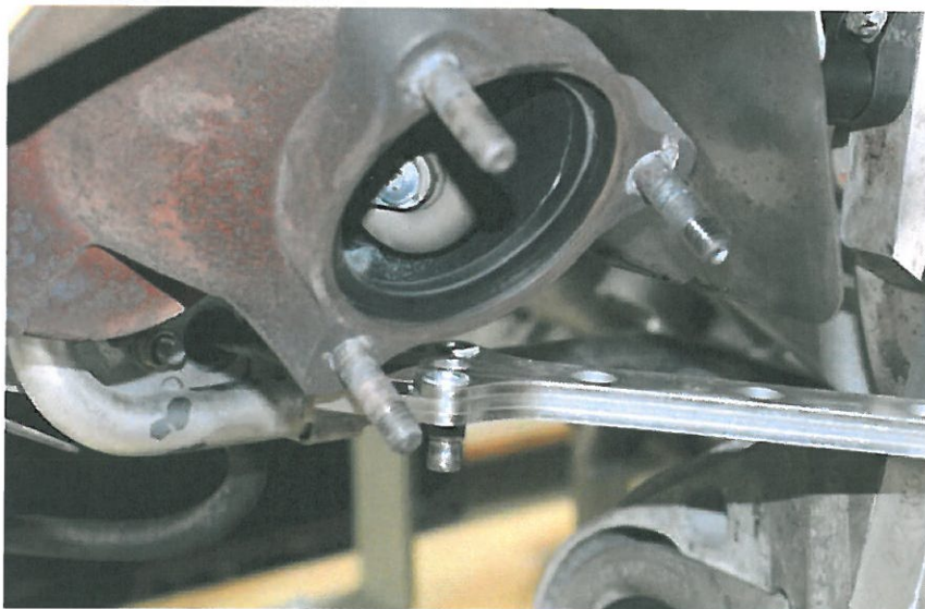
Bild 2 Wastegatehebel mit Gegenhalter in Position halten
