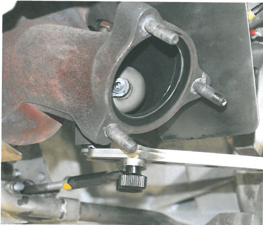
Bild 4 Befestigung des Führungswerkzeuges am Gegenhalter
