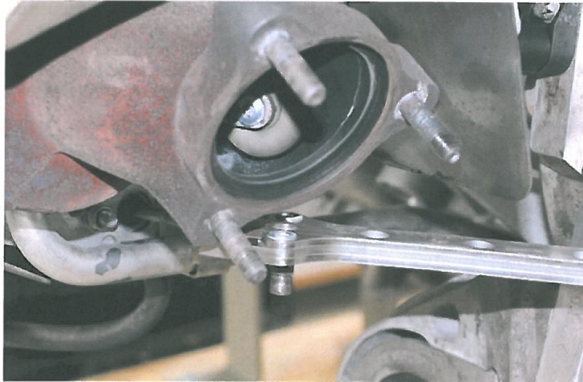
Bild 2 Wastegatehebel mit Gegenhalter in Position halten
