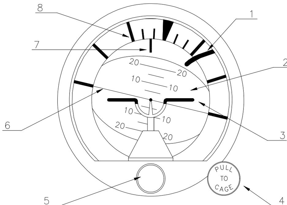
1. **Warnsignal für die Stromversorgung (Power Warning Flag)** - Wenn dieses Signal sichtbar ist, zeigt es an, daß der künstliche Horizont nicht mit Strom versorgt wird. Wenn das Signal nicht sichtbar ist, wird angezeigt, daß die Stromversorgung eingeschaltet ist.
