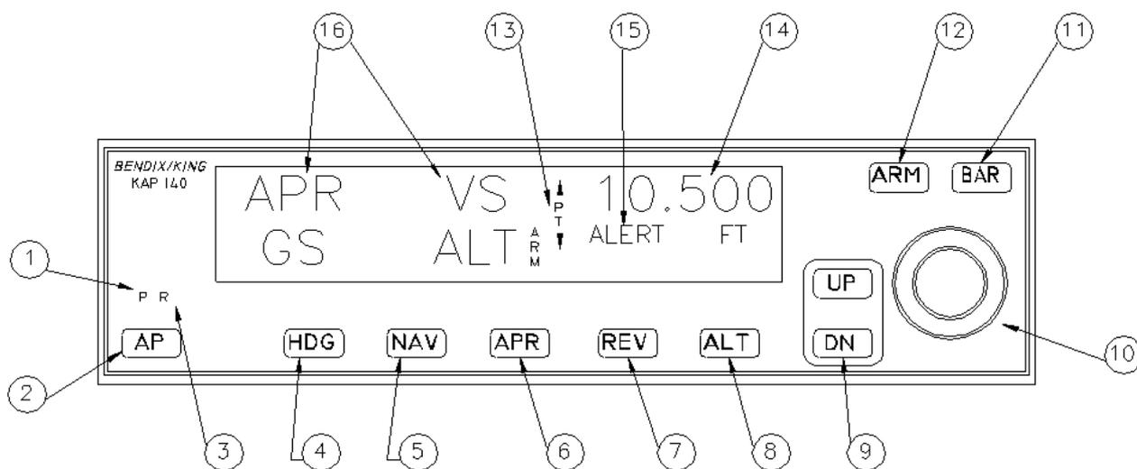
1. NICKACHSE, 'P'-ANZEIGE - Wenn sie leuchtet, zeigt dies eine Fehlfunktion der Nickachse an. Entweder wird der Autopilot deaktiviert oder die Aktivierung der Nickachse verhindert. Die 'P'-Anzeige kann auch leuchten, wenn der Autopilot deaktiviert ist. Dieser Zustand kann sich bei Flugmanövern ergeben, bei denen die Schwellwerte für das Lastvielfache überschritten werden. Der 'Autopilot Monitor' verhindert das Aktivieren solange 'P' leuchtet.
